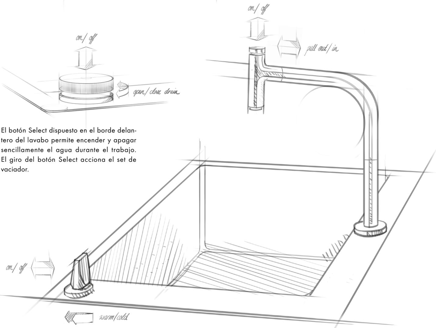
El botón Select dispuesto en el borde delantero del lavabo permite encender y apagar sencillamente el agua durante el trabajo. El giro del botón Select acciona el set de vaciador.
