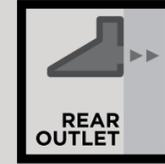
Disponible en muchas campanas FABER, la salida de aire posterior permite canalizar el flujo de humos hacia la parte trasera de la campana, eliminando el tubo superior y disfrutando el espacio sobre el extractor.
