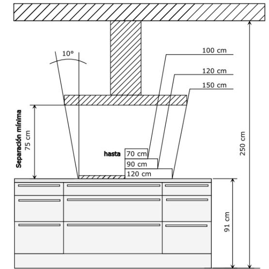
Se alcanza el rendimiento de aspiración óptimo si la campana se encuentra montada a una altura de 750 mm de la superficie de cocción.
