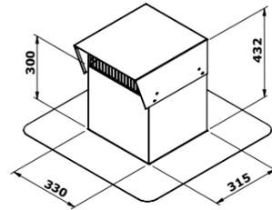
> TZ 223 Brida de sellado para el paso del techo plano (tejado plano no aislado)
