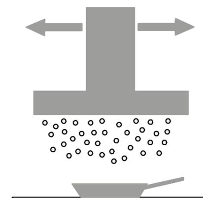
Los modelos de recirculación se diferencian de los modelos de extracción en el hecho de que el humo aspirado no se dirige hacia el exterior, sino que se limpia tras pasar por unos filtros de grasa y carbón que devuelven el aire limpio a la cocina. Al igual que en los modelos de extracción, la grasa se retiene en filtros metálicos de varias capas y los olores del humo se neutralizan en filtros de carbón activo.
