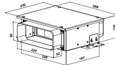
› TZ 211 Elemento de recirculación con filtro de carbón activo en forma de panel
