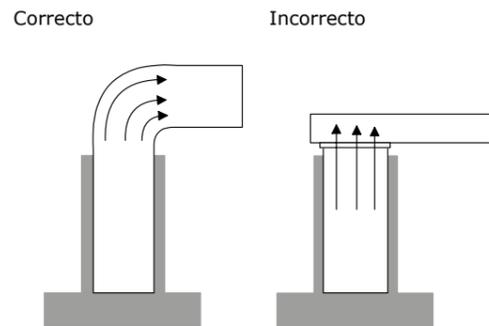
Dado que el flujo de aire puede causar ruidos, es preferible no utilizar tubos metálicos, ni ductos de plástico rígido, ni ductos flexibles de metal. Los conductos con cuerpo rígido, así como los de material duro, transmiten mayor ruido que los flexibles o los blandos.
