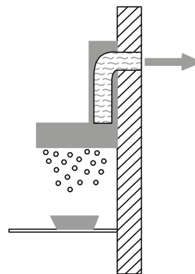
Los modelos de extracción son la solución ideal para eliminar de la cocina los vapores que se forman durante la cocción. Existe una diferenciación fundamental entre los modelos con motor interno y los modelos apropiados para el uso de motores externos.
